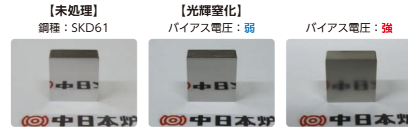
● ASP窒化 ～標準データ～ 処理温度：480℃ / 処理時間：5時間
